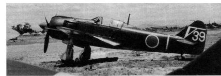
飛行第 5 戦隊の五式戦一型。水漬状風防に変更した新鋭生産機である
