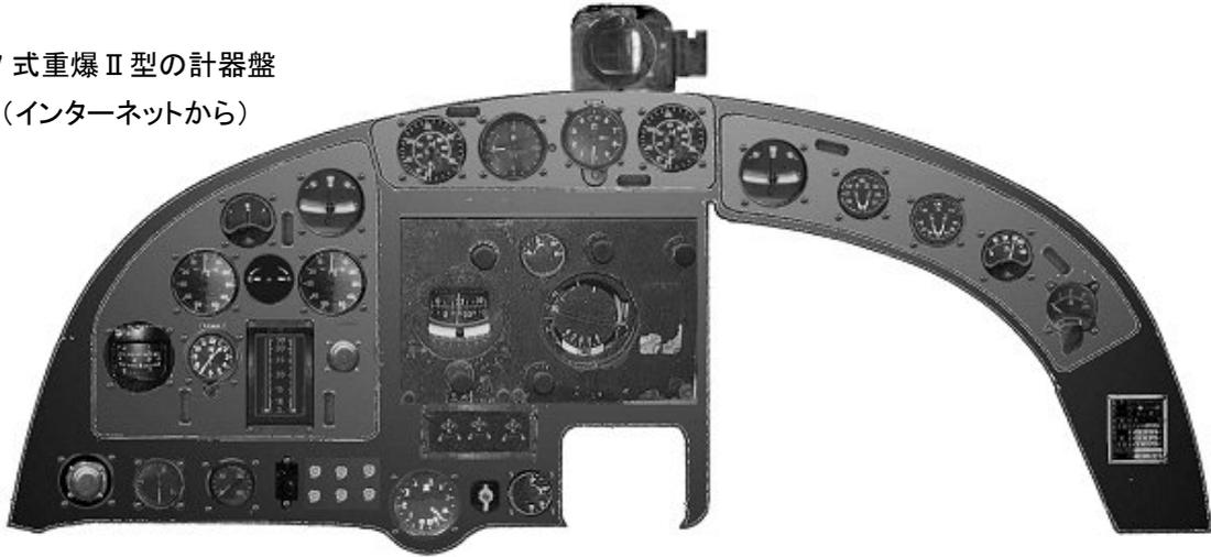
羅針儀(98式乙)、自動操縦装置(95式)、航路指示器、旋回計(98式)、速度計(98式)、高度計(97式)、昇降計(95式2型)、時計、回転計(98式)、同調計、吸入圧力計(98式)、シリンダー温度計、排気ガス計(2型)、油温計(89式)、油圧計、燃料計、燃料圧力計(1式)
