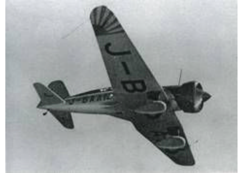
神風号 8) (最高速度 450km/h は、戦闘機を凌ぐ。発動機は中島「寿」性能向上型)
